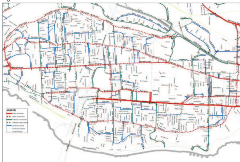
Figure 21 : Plan de la hiérarchie du réseau routier
