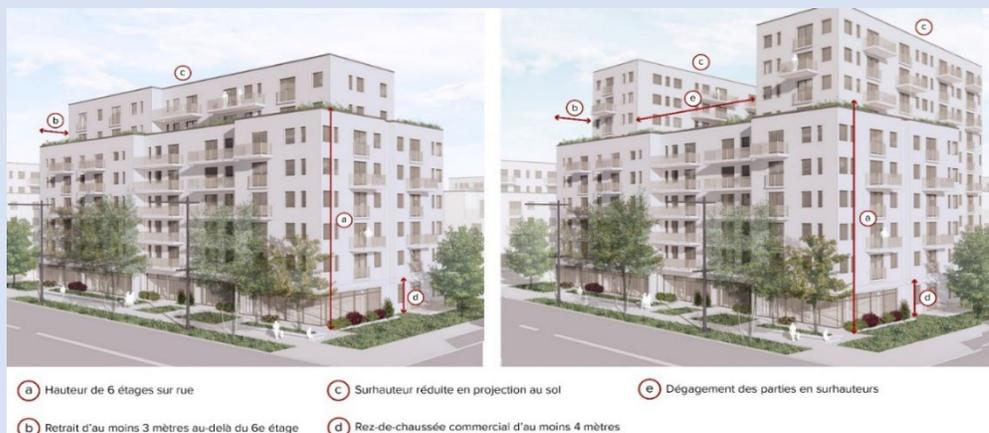
Figure 30 : Principes relatifs à l'encadrement des sur hauteurs
